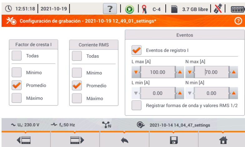
Fig. 9. Configuración de registro - parámetros de corriente.
