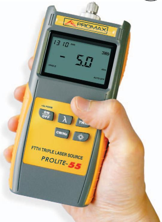
El **PROLITE-55** puede transmitir un protocolo digital encriptado con una identificación de la longitud de onda, permitiendo al medidor de potencia **PROLITE-63B** cambiar automáticamente a la longitud de onda calibrada adecuada. Esta característica reduce la necesidad de comunicación entre los dos usuarios y minimiza la posibilidad de errores.
