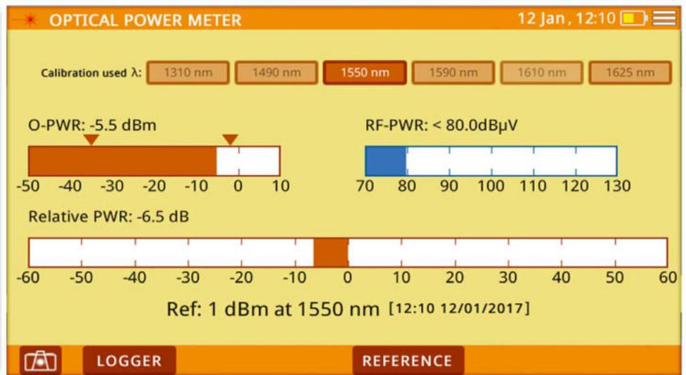
En este modo se muestra la medida de potencia óptica junto al resto de las medidas de RF. RFoG (*Radiofrequency-over-Glass*) es utilizado por los operadores de CATV porque les permite beneficiarse de las ventajas de la fibra óptica para competir con los proveedores de servicios FTTH.
