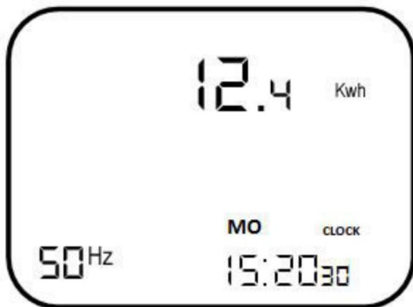
Pulse la tecla MODE para cambiar al rango CO2/kg. Aquí puede comprobar un valor orientativo para los valores de emisión de CO2 generado de la potencia medida previamente, el factor de potencia, día de la semana y hora actual. El valor CO2/kg se refiere a un suministro al 100% de potencia suministrada por carbón y se calcula por las emisiones teóricas de CO2 de 0.792 kg/kWh. Si su proveedor de energía le ofrece una mezcla diferente de energía, puede restar ese valor de porcentaje.
