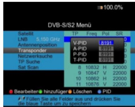
5. **Netzwerksuche:** Bei aktivierter Netzwerksuche erhält das Messgerät ggf. erweiterte Informationen vom Transponder um z.B. neue Sender zu finden, welche noch nicht in den internen Gerätedaten hinterlegt wurden. Betätigen Sie die ◀Links/Rechts▶-Tasten zum Umschalten der Option.
