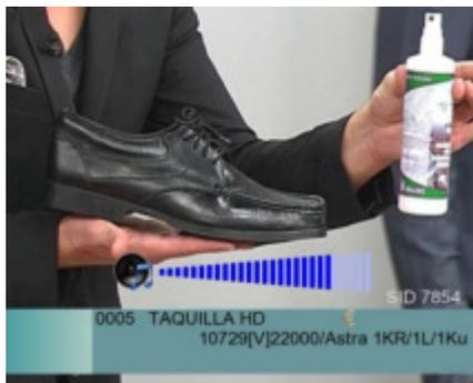
8. **F1-Taste:** Betätigen Sie im Live-TV Bild die F1-Taste erscheint ein Informationsfeld zu dem aktuellen Sender mit Angaben zum Signalpegel und der Qualität, sowie Angaben zum Transponder und Sender:
