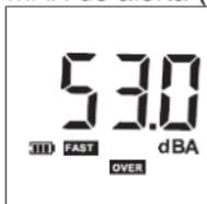
Cuando se detecte que el nivel de sonido está por encima del valor establecido el dispositivo emitirá una señal acústica y el LED comenzará a parpadear (01 = modo de alarma 1) o solamente un parpadeo LED (02 = modo de alarma 2). La alarma parará a los 15 segundos.
