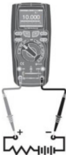
1. De acuerdo con la corriente que se vaya a medir, gire el selector de función a la posición de  $\mu\text{A}$ ,  $\text{mA}$  o  $10\text{A}$ .
