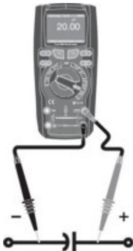
1. Coloque el selector en la posición " $\Omega$   $\rightarrow$   $\dashv$  /CAP".
