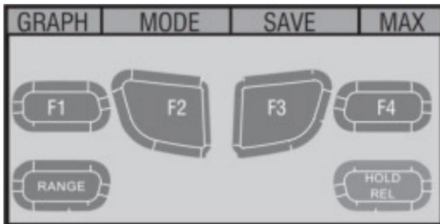
Las 6 teclas de la parte frontal del medidor activan características que aumentan la función seleccionada usando el selector, menús de navegación o control de potencia para medir circuitos.
