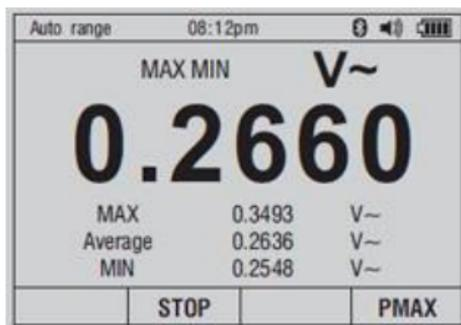
Para activar el modo "MAX MIN", pulse la tecla "F4" (MAX MIN) en el modo de medición.
