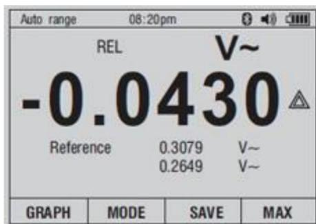
Si pulsa la tecla “REL”, usted puede medir el valor relativo y el indicador “REL” aparecerá en la pantalla en el modo relativo. ¿Qué entendemos por el valor relativo? Pulse la tecla “REL”, el medidor toma su primera medición como valor de referencia (usted debe decidir un valor de referencia como señal de entrada), y el medidor guardará la lectura mostrada como valor de referencia.
