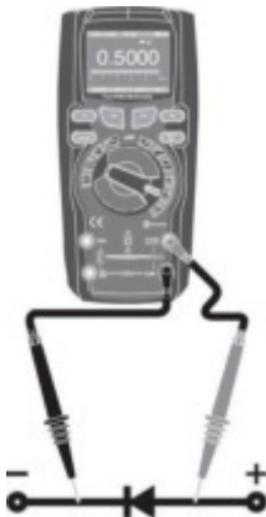
1. Coloque el selector en la posición " $\Omega$ -
