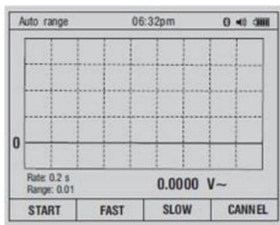
Pulse la tecla de pantalla "F1" (START). Pulse las teclas "F2" (FAST) o "F3" (SLOW) para seleccionar la frecuencia de muestreo. Pulse "F4" (CANNEL) para salir de la medición gráfica y volver al modo de medición normal.
