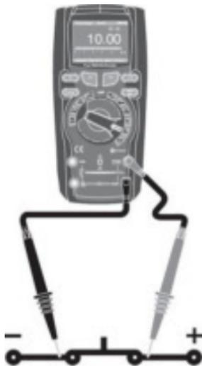
1. Coloque el selector en la posición " $\Omega$ —▶—/CAP".
