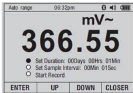
Pulse la tecla "F3" (SAVE). Luego, pulse la tecla "F3" (DOWN) para seleccionar el elemento RECORD del menú y pulse la tecla "F1" (ENTER).
