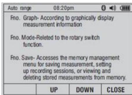
Con las teclas "F2" y "F3" es posible desplazarse hacia delante o hacia atrás dentro de la función de ayuda (HELP). Para volver al menú "SAVE", pulse la tecla "F4" (CLOSE).
