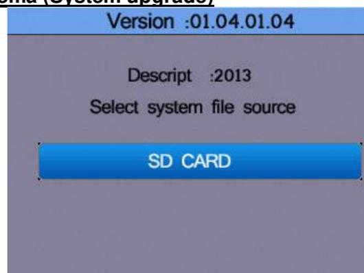
Si está disponible una actualización de firmware, se puede almacenar en una tarjeta SD que sirve como fuente para la actualización. La actualización de firmware solamente se debe llevar a cabo por personal cualificado, ya que una aplicación incorrecta puede dañar la unidad.
