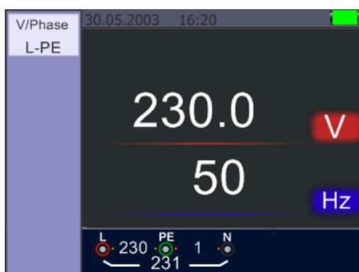
Pantalla en medición de tensión y frecuencia
