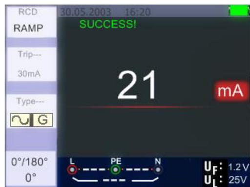
**RCD Ramp – Pantalla de medición**
