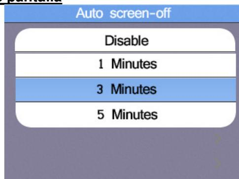
Es de 3 minutos por defecto. Pulse los cursores ▲ y ▼ para seleccionar el tiempo de apagado automático de pantalla deseado y pulse el botón ESC para salir y guardar. Para prolongar la vida de las pilas, la pantalla se apagará de forma automática tras unos minutos, ya que la retroiluminación es la opción que más consume del dispositivo.
