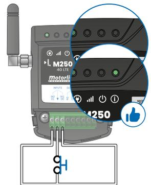
6 • El LED ACT se encenderá de nuevo y permanecerá encendido. **El Reset se completa tan pronto como el LED ACT se apaga y se vuelve a encender.**
