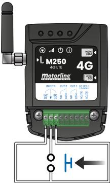
1 • Haga un puente (Shunt) entre IN1 y IN2 y prepare una conexión a GND como se muestra en la imagen;
