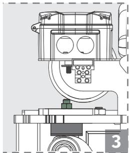
3 Coloque el mastil en la posición deseada y gire el tope de apertura hasta que toque la palanca
