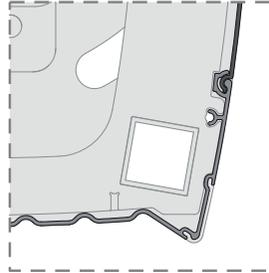
3 Inserte la **PUERTA** sobre ella colocándola a 90° con el lado frontal de la barrera y encajándola en la ranura a lo largo del **PERFIL LATERAL**.
