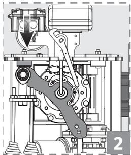
2 Coloque el mastil en la posición horizontal deseada y gire el tope de cierre hasta que toque en la palanca.
