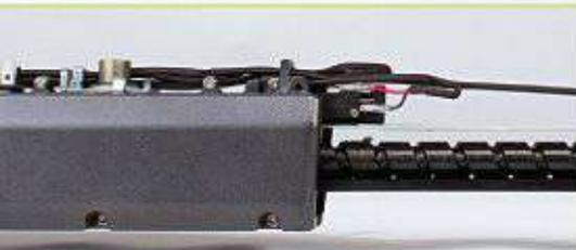
**3 finales de carrera** de alta seguridad con switch, cortan la alimentación independientemente de la electrónica./ uno de ellos es para emergencias.
