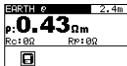
Figura 7.7: Ejemplo de resultado de la medición de la resistencia de tierra específica
