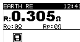
Figura 7.13: Ejemplo de resultado de la medición de resistencia de tierra
