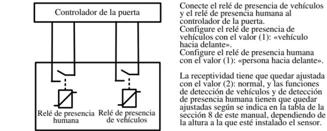
**EJEMPLO 3: controlador de la puerta con 2 entradas de relé: una ajustada para abrir completamente la puerta cuando se acerque un vehículo y otra para abrirla a medias cuando se acerque una persona.**
