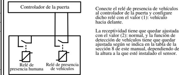
**EJEMPLO 2: controlador de la puerta con 2 entradas de relé: una para activar la puerta industrial y otra para activar una puerta distinta para el acceso de peatones.**
