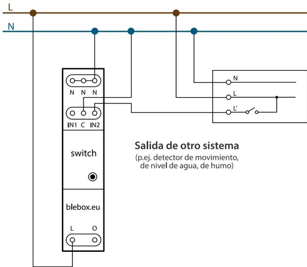
Salida de otro sistema (p.ej. detector de movimiento, de nivel de agua, de humo)
