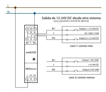
Luego de asegurarse de que el dispositivo esté conectado, de acuerdo con el esquema y que cerca del controlador no hay partes metálicas que puedan crear accidentalmente cortocircuito, encienda el dispositivo conectándolo a la fuente de alimentación (conectando el fusible de la instalación de la red eléctrica o el cable de alimentación a la toma).
